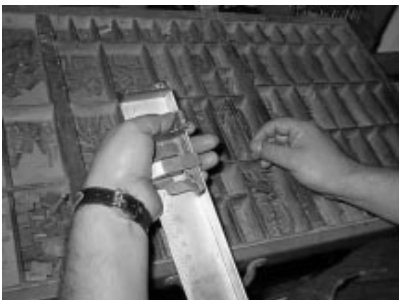
Figura A. Ordenamiento de los caracteres de una página en un componedor.
