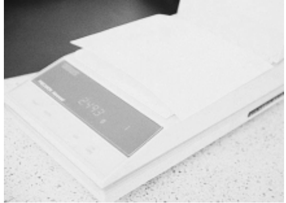
Figura 4. Balanza analítica para determinar el peso base.
